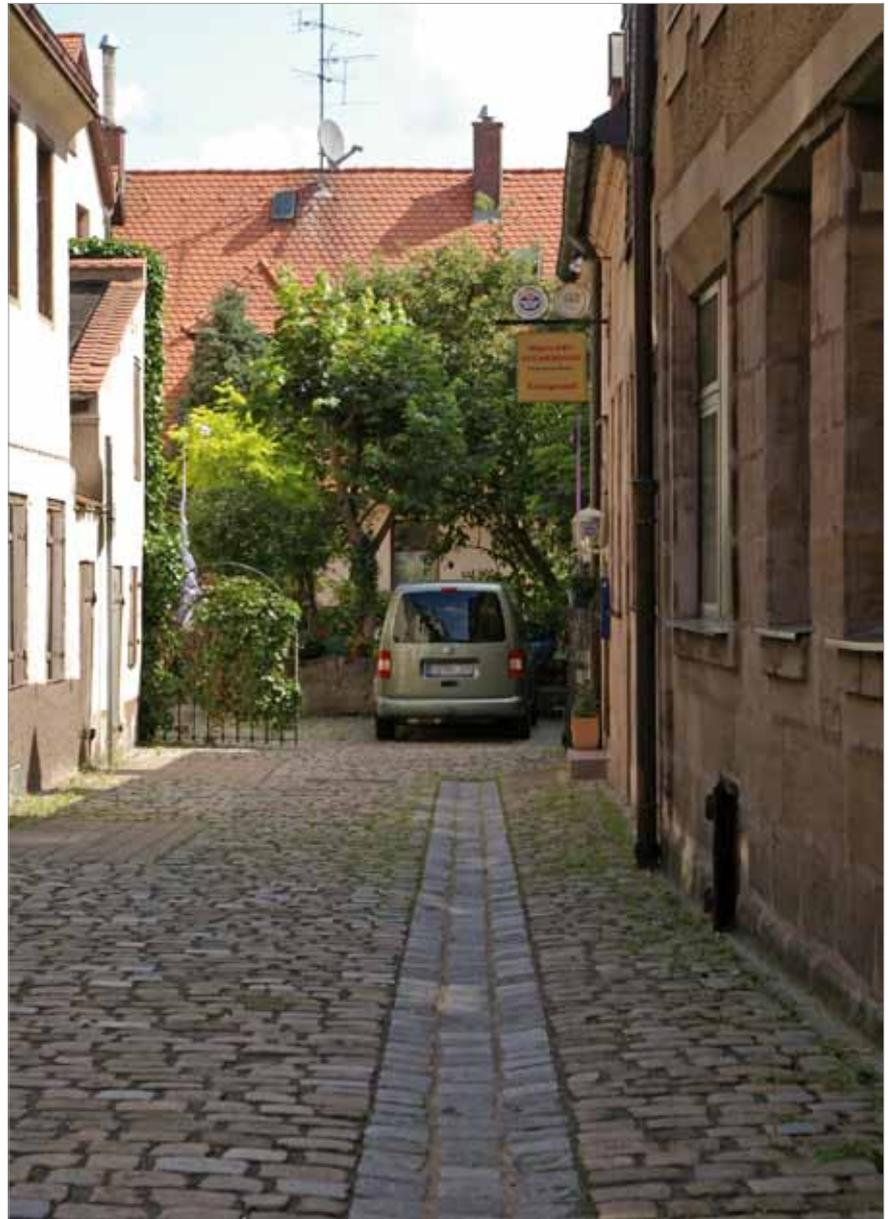
Sanierter Straßenbelag unter Verwendung von gebrauchtem Großsteinpflaster
